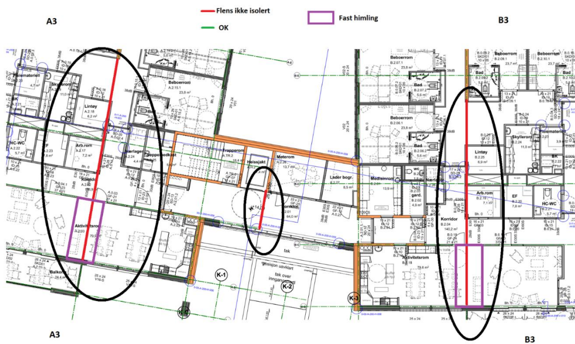
Figur 9: Ståldrager med utilstrekkelig utført brannisolasjon (Tromsø kommune).
