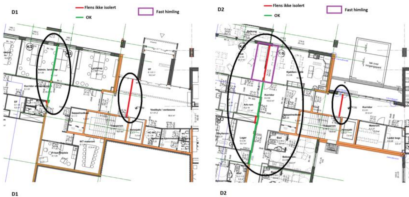
Figur 11: Ståldrager med utilstrekkelig utført brannisolasjon (Tromsø kommune).
