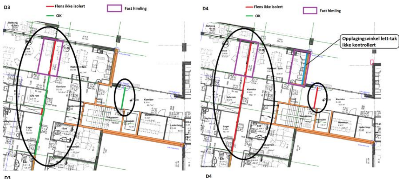
Figur 12: Ståldrager med utilstrekkelig utført brannisolasjon (Tromsø kommune).
