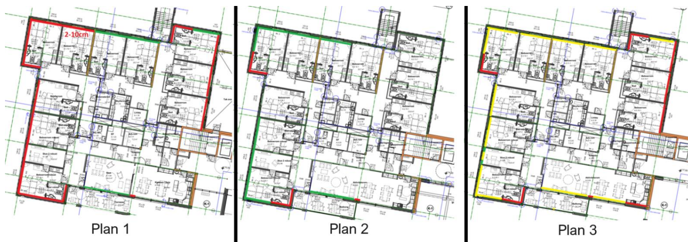
Figur 3: Oversikt over utførelse i bygg A. Rød = >7 cm åpning, gul = 2-7 cm åpning, grønn = OK utførelse. Figur oversendt fra Tromsø kommune med fargekoder.
