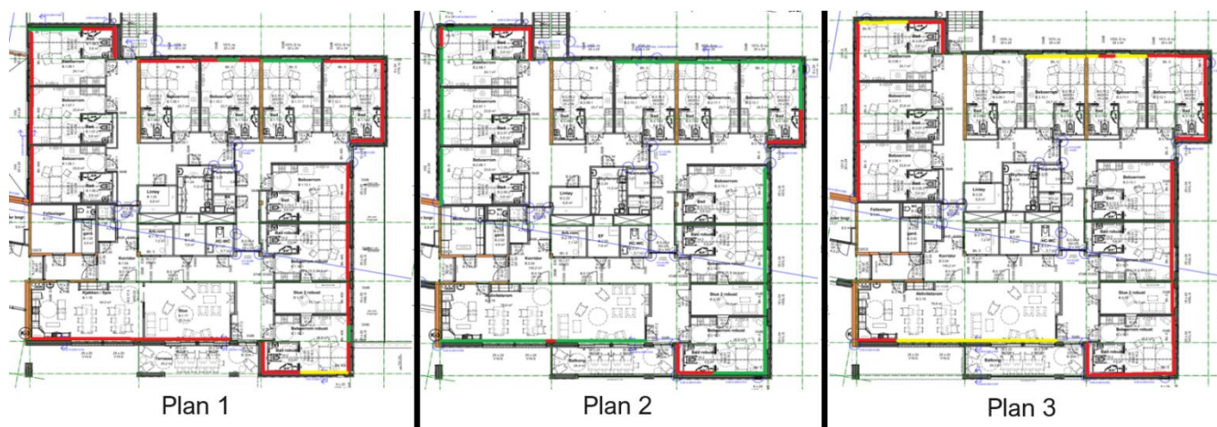
Figur 4: Oversikt over utførelse i bygg A. Rød = >7 cm åpning, gul = 2-7 cm åpning, grønn = OK utførelse. Figur oversendt fra Tromsø kommune med fargekoder.
