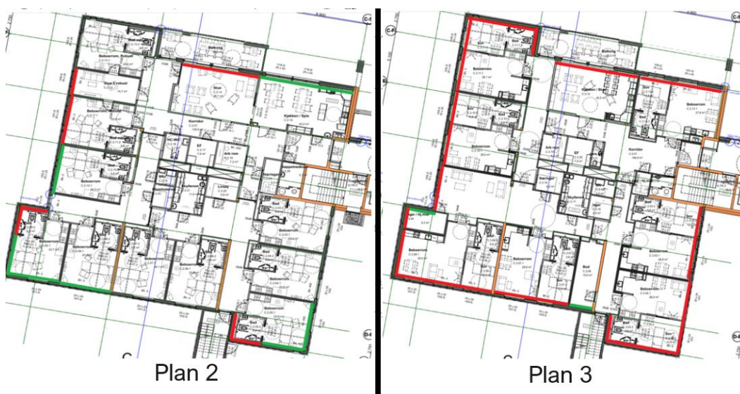
Figur 5: Oversikt over utførelse i bygg A. Rød = >7 cm åpning, gul = 2-7 cm åpning, grønn = OK utførelse. Figur oversendt fra Tromsø kommune med fargekoder.
