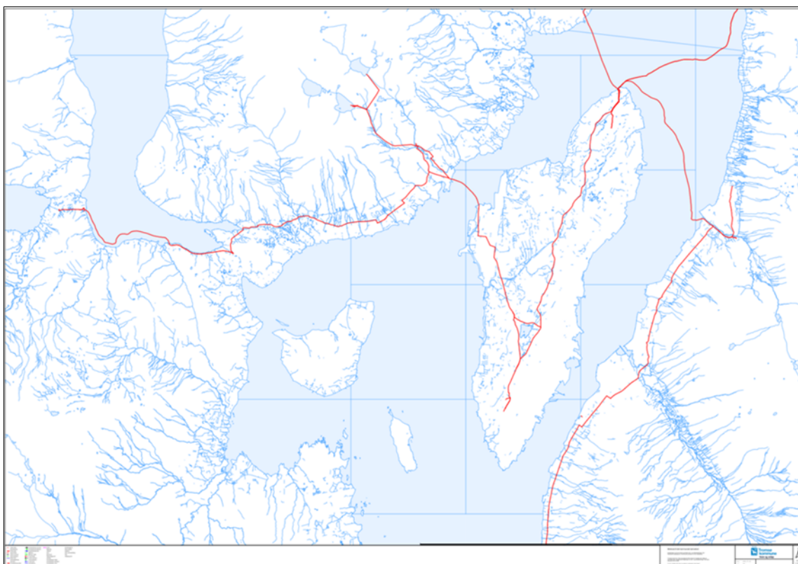
Figur 12: Oversikt over vannledninger som defineres som overføringsledninger.
